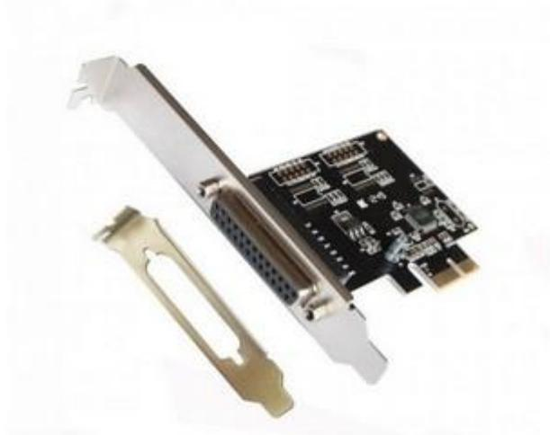
Tarjeta PCI Express 1 puerto paralelo con adaptador para perfil bajo.
